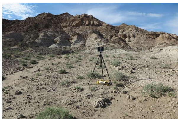
図 1. ゴビ砂漠ホンギルツァフにおける地形調査に使用中の FARO Focus3D
