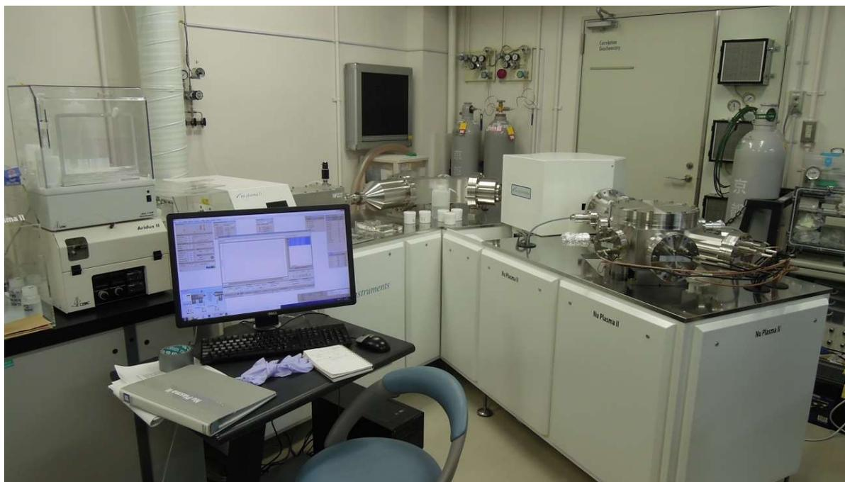
高精度磁場偏向型質量分析装置
